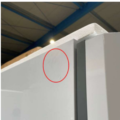
Leichte Beschädigung der Oberfläche an der linken Seitenwand oben
