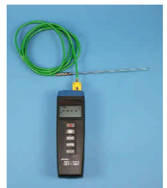
MIN/MAX Thermometer mit zusätzlichem Temperaturfühler
