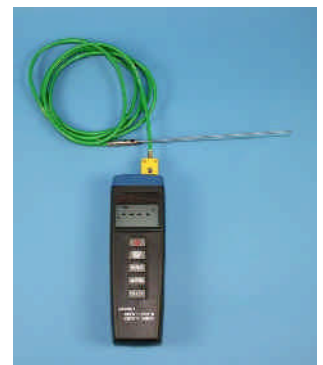
MIN/MAX Thermometer mit zusätzlichem Temperaturfühler
